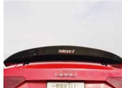
カーボントラックスポイラーもバランスイット製。RS 5の昇降式トラックスポイラーの空力性能を高める。
